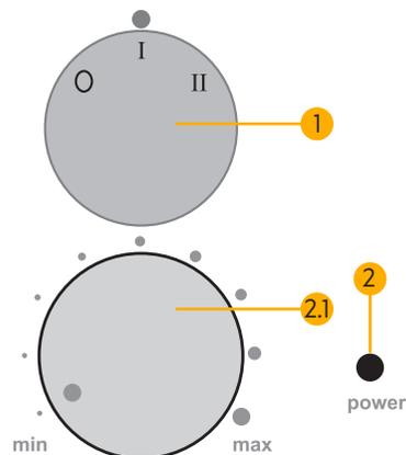
1. На верхней части блока управления находится регулятор мощности обогревателя.
