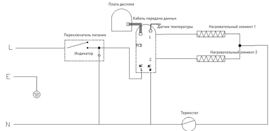
Схема устройства может незначительно отличаться.
